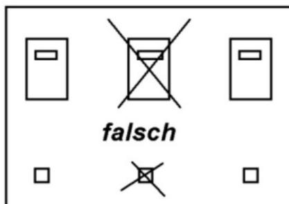
Der Spiegel soll stets an zwei Punkten aufgehängt werden. Deshalb verwenden Sie bitte nicht mehr als ein Set je Spiegel. Ist der Spiegel schwerer als 12 kg, so ist die größere Spiegelaufhängung VITOFIX PLUS I zu verwenden, die bis zu 24 kg tragen kann.
