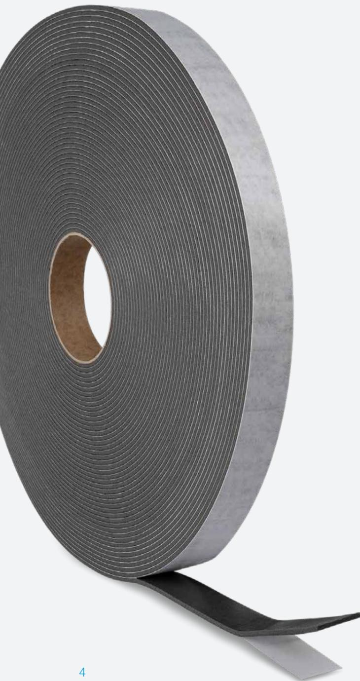
Der Polyvinylchloridschaum mit weitgehend geschlossenzelliger Struktur ist mit einem modifizierten Acrylatklebstoff beschichtet. Die Rollen sind so gewickelt, dass die Haftklebeschicht innen liegt (bis 10 mm Dicke; bei größeren Dicken ist der Klebstoff abgedeckt). Das Dichtungsband hat eine gute mechanische Festigkeit. Es ist flexibel und schmiegsam, so dass es sich problemlos an unebene Oberflächen anpasst. Dadurch wird eine optimale Abdichtung erreicht.
